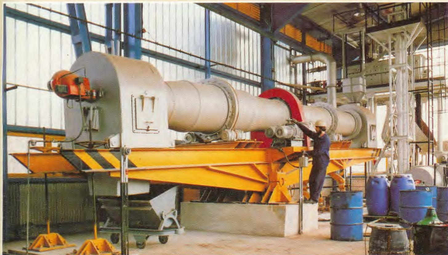
A tokodi kísérleti állomásra telepített hidrometallurgiai üzem a gyenge minőségű és fizikai módszerekkel nem dúsítható ércek és ásványi anyagok hasznosítására szolgál. Kidolgozott technológiák: karbonátos ércek és közeket feldolgozása.
