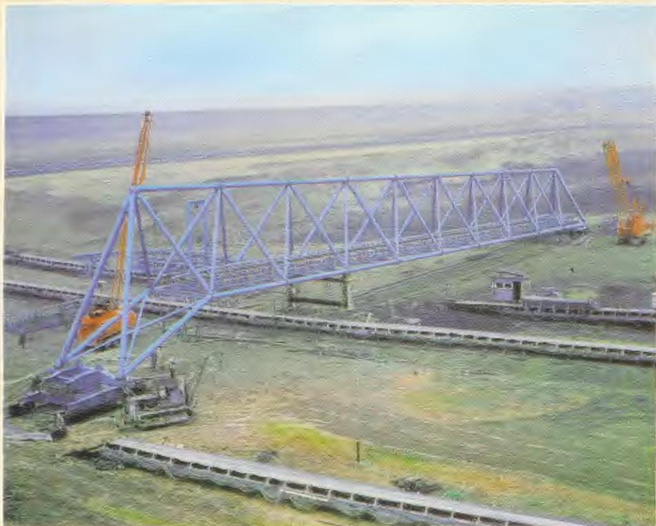
A külfejtésből a szén közvetlen kiszállítására készített új elgondolásunk a mozgatható rézsűhid gyakorlati megvalósulása a visontai külfejtésben. Hasonló terv készült a közelmúltban Jugoszlávia részére is.
