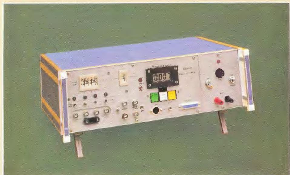
A COMEx2 CMOS mikroprocesszoros szállítószalag vezérlő rendszer egyik egységének bemérése az intézet által kifejlesztett mérőberendezéssel.
