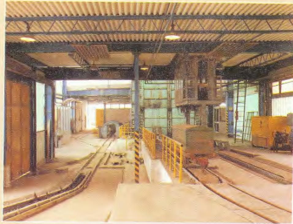
A Márkushegyi bányaüzem külszíni aknarakodója, ahová depressziós aknaház helyett elektrohidraulikus működtetésű zsírpelőszekrényt tervezünk.
